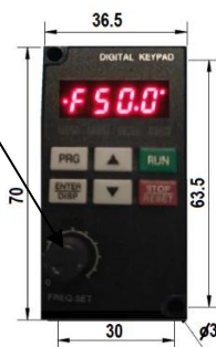
TYP A Potenciometer POT na externom panelu
