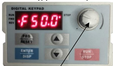
TYP A Potenciometer POT na externom panelu
