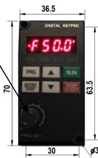
TYP A Potenciometer POT na externom panely
